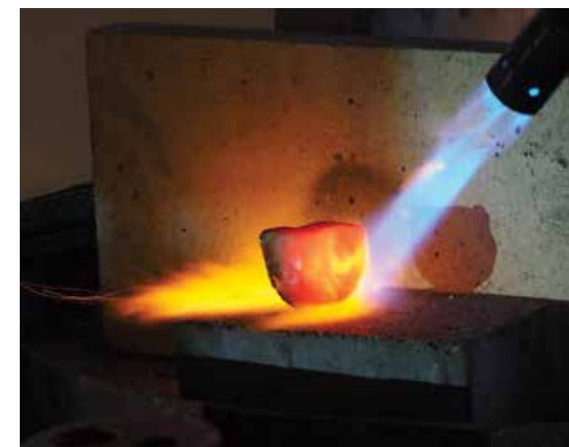
Ezüstolvasztás saját készítésű tégelyben (Varga Gábor János „találománya”), 2019 Melting silver in self-made crucible (Gábor Varga's 'invention'), 2019 Fotó: Lenzsér-Mezsei Kata
