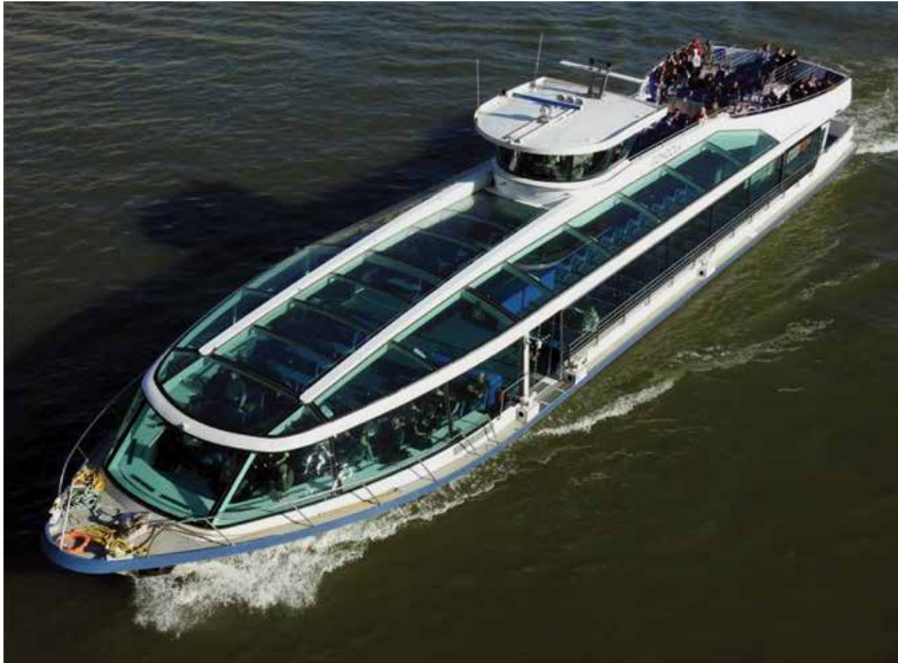
Gondola motoros hajó. Formaterv: CSEPREGI Sándor, NÁDAS Gergely (ABN Design Kft.). Tervezés: Pelsoproject Kft. Kivitelezés: MSK Steel Kft. Építető: Budapest Gondola Kft. | Gondola sightseeing ship. Form design: Sándor CSEPREGI, Gergely NÁDAS (ABN Design Kft.). Planning: Pelsoproject Kft. Execution: MSK Steel Kft. Customer: Budapest Gondola Kft. | 2016–2018, 39,66x8,40 m, merülés: 1,35 m, vízkiszorítás: 189 t, utasszám: 250 fő Fotó: Kosztolicz Péter
