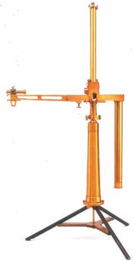
Süss Nándor által készített Eötvös-inga (horizontális variométer) The Eötvös torsion balance made by Nándor Süss (horizontal variometer) 1898
